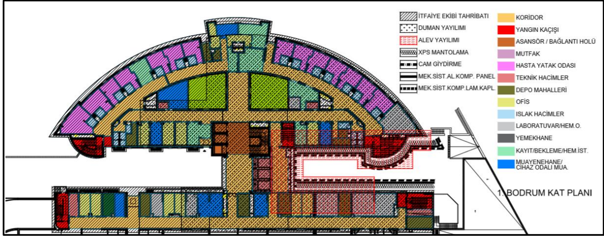
Şekil 9. Birinci bodrum kat planı (İşlevsel analizi, cephe sistem kuruluşu ve yangın etki bulguları)
